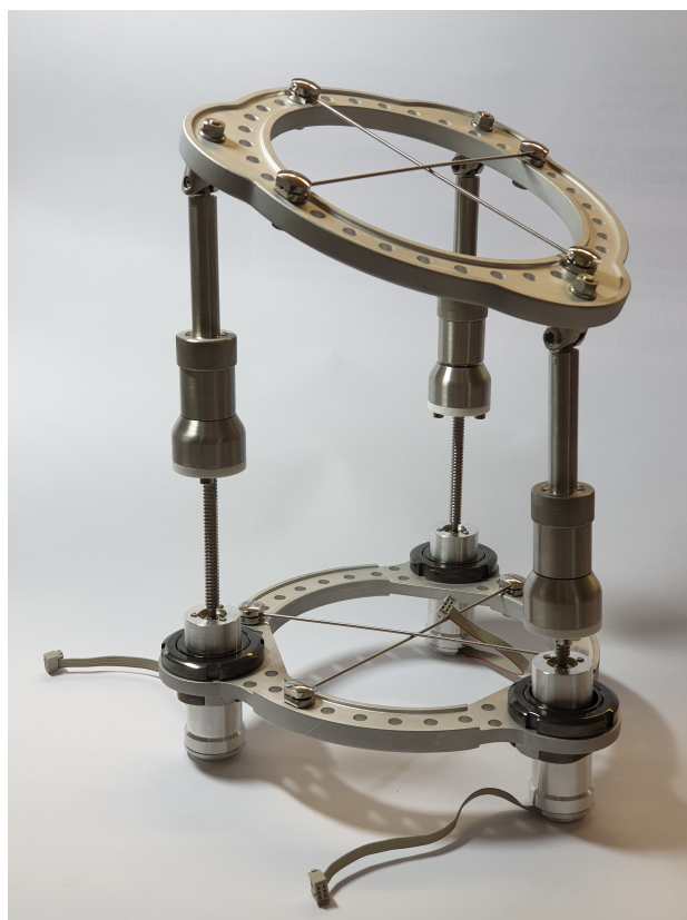
Obr. 6.1: Prototyp zevního fixátoru typu Ilizarov osazený trojicí motorů s možností směrové korekce a dynamického buzení posunutí.
