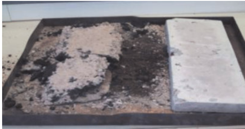
Obrázek 3 – porovnání vzorků asfaltu (vlevo) a betonu (vpravo) po zahřívání na 750 °C
