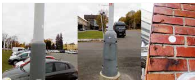
Obr. 3 Signalizace vlíčovacích bodů odraznými terči
