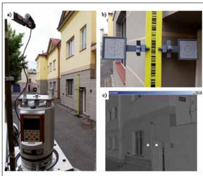
Obr. 8 a) Měřicí souprava b) odrazné štítky, c) zobrazení odrazných štítků v softwaru
