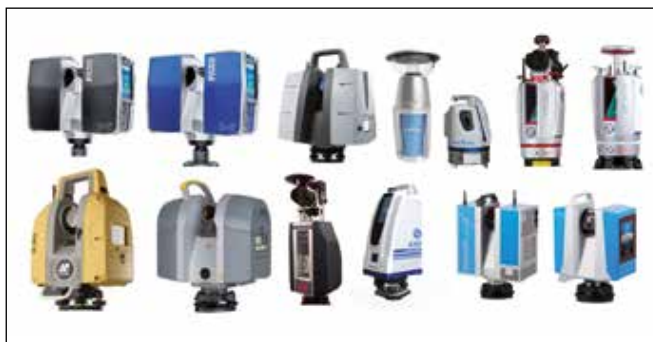
Obr. 6 Přehled 3D optických skenerů FARO X130 a X330, Leica ScanStation P50, Neptec OPAL-360XP, Polaris Optech, Riegl VZ-400i a VZ-2000i, Topcon GLS-2000, Trimble TX6, Smart Max VS1000, Stonex X300 Z+F IMAGER® 5016 a Z+F IMAGER® 5010X [12–21]
