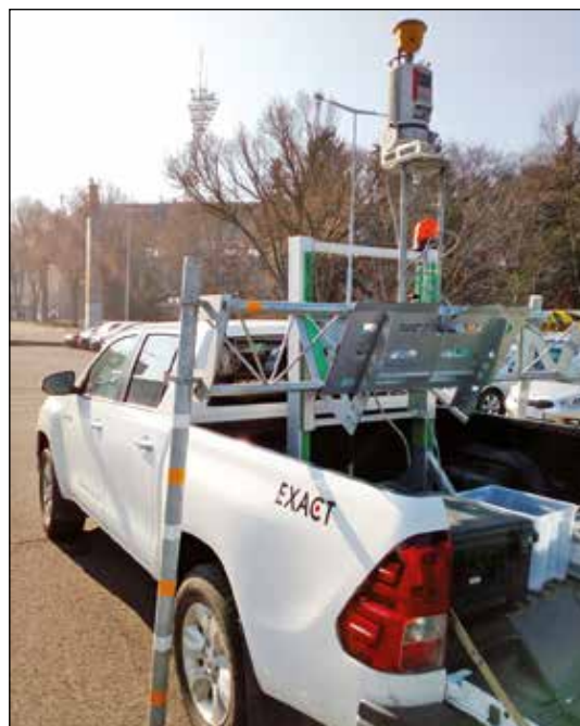
Obr. 4 Skener na stanovisku s nucenou centrací
