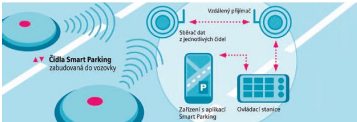
Obrázek č.8: Fungování zemního parkovacího senzoru (zdroj: Siemens s.r.o.: Chytrá města-Jak efektivněji spravovat město a zvyšovat kvalitu života jeho obyvatel)
