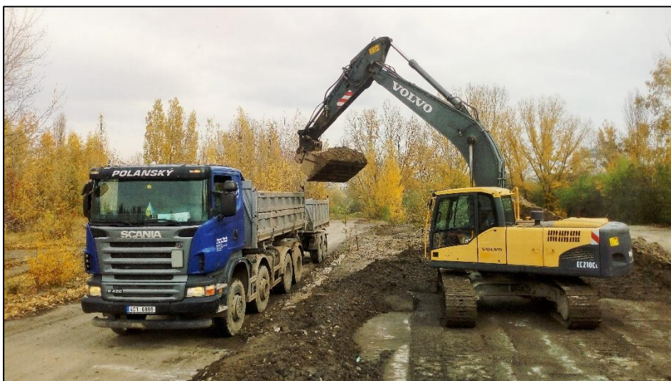
Obr. 2 – Volvo 210 při nakládání soupravy typu 8x6 S3 + tandemový vlek S3, foto: autor
