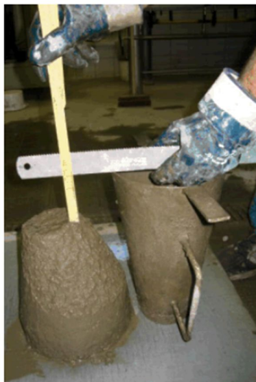
Obrázek 6.29 Výsledky zkoušky sednutí kužele [31]
