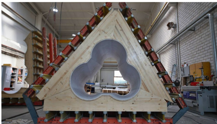
Obrázek 2.4 Speciální forma společné části šikmých sloupů. [3]
