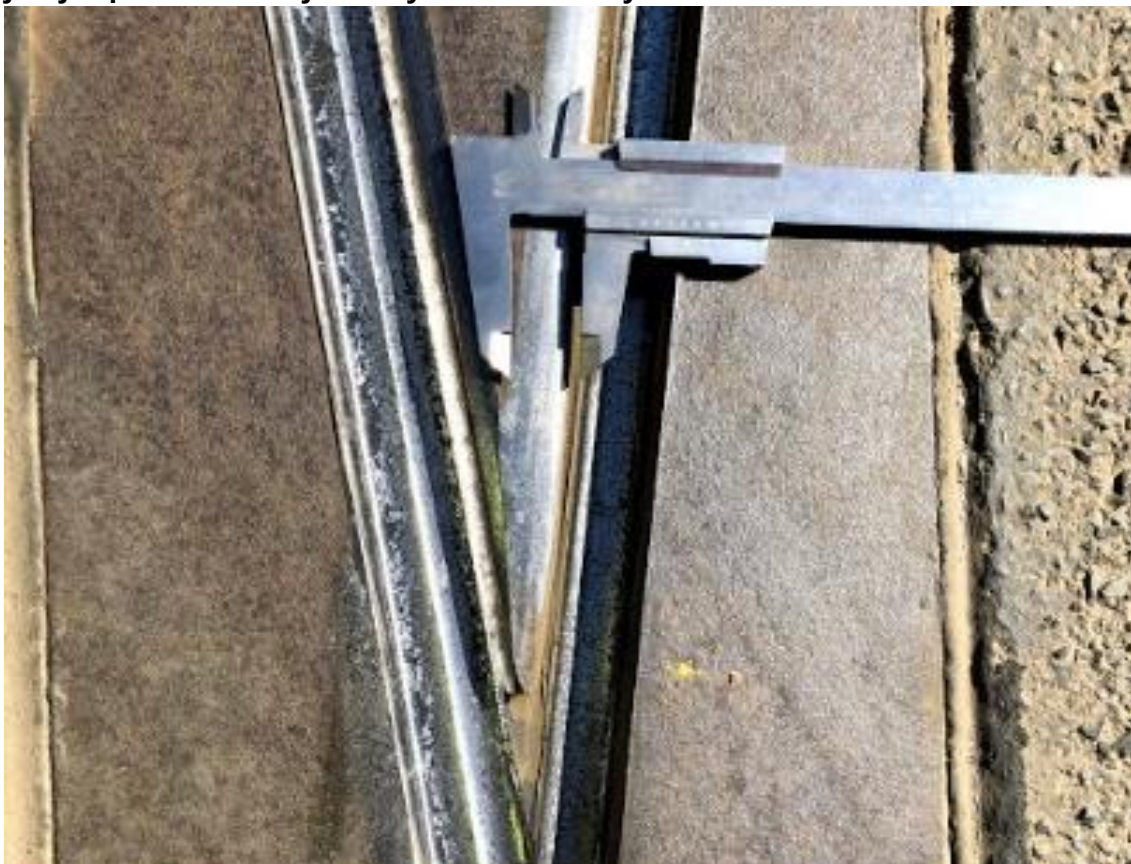
Obr.53-Ojetí hrotů srdcovky. Šířka ojetí měřená posuvným měřítkem činí přibližně 19 mm.
