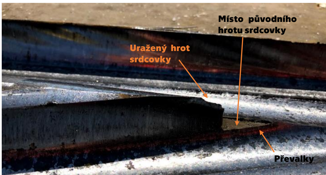
Obr.55-Uražený hrot srdcovky
