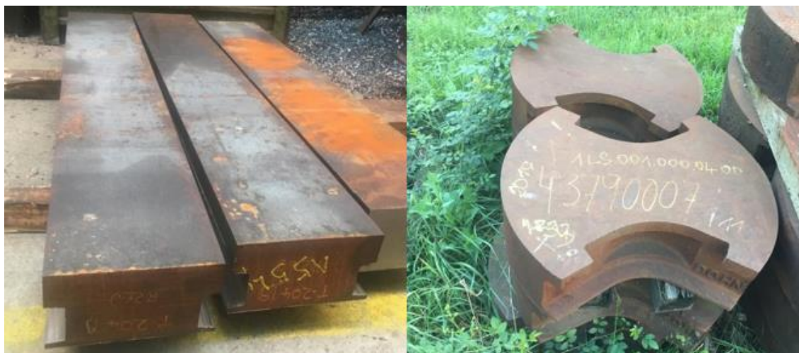
Obr.9-Ocelolitinový blok připravený pro výrobu tramvajové srdcovky. Tyto bloky mohou mít různý tvar, který je závislý na úhlu křížení. [5]
