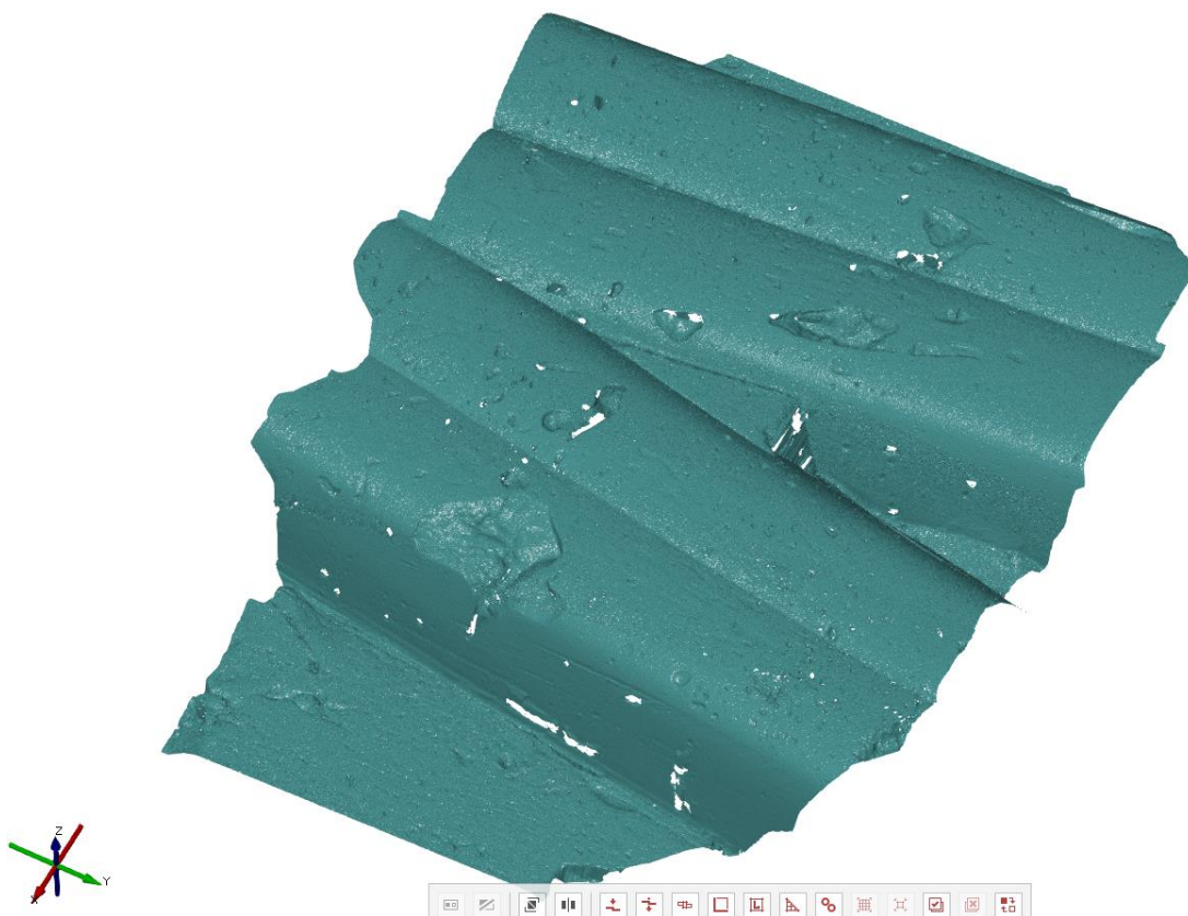
Obr.32-Výsledný sken sádrového odlitku
