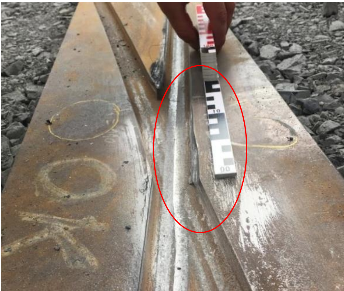
Obr.38-Střed srdcovky Spojovací č.2 s uraženým hrotem křídlovky
