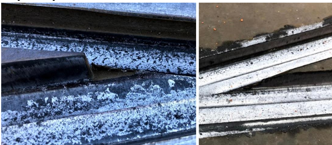
Obr.48-Dvojžlábek vytvořený v srdcovce Výtoň (v levé části obrázku) a Spojovací č.2 (v pravé části obrázku)
