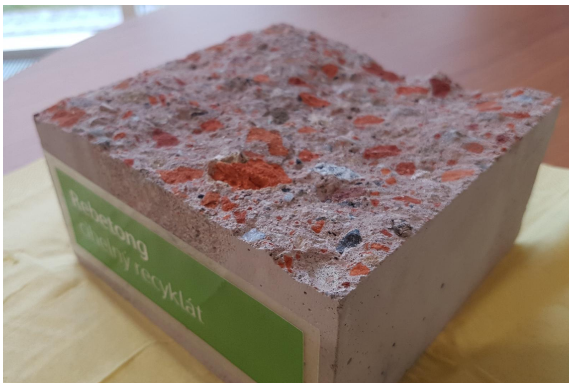
Obr. 7: Beton s cihelným recyklátem Rebetong [25]
