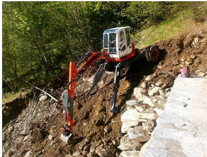
Obr. 9: Kráčivý podvozek (Zdroj:[26])
