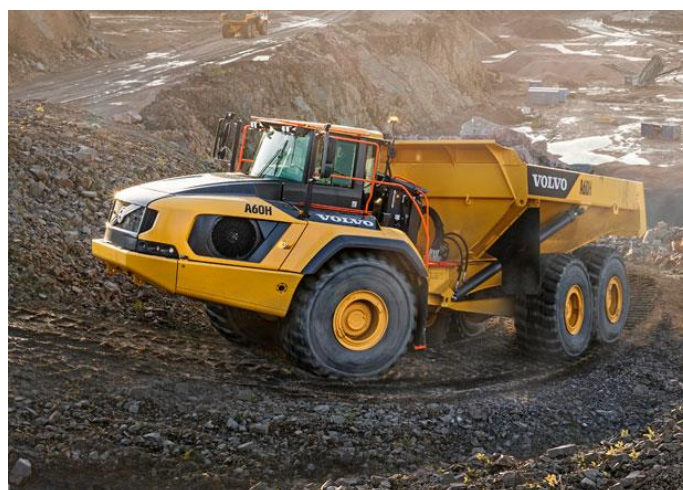
Obr. 27: Dempr s kloubovým rámem (Zdroj:[33])
