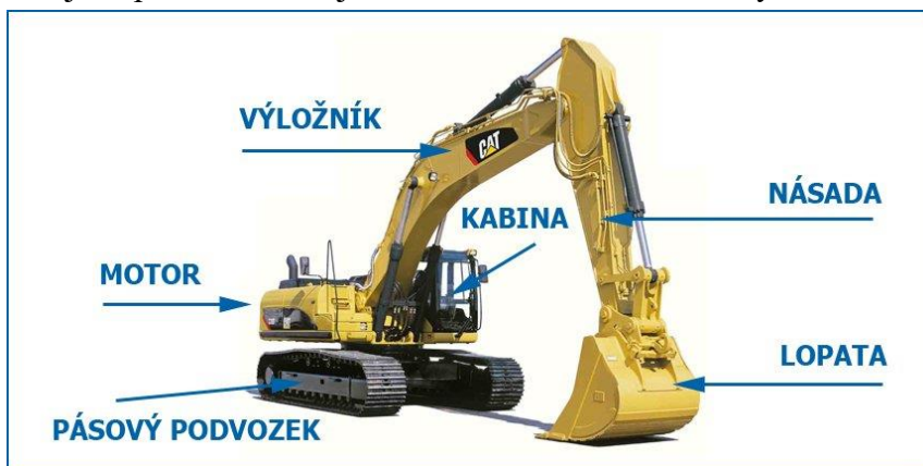
Obr. 1: Složení rypadla (Zdroj:[8])
