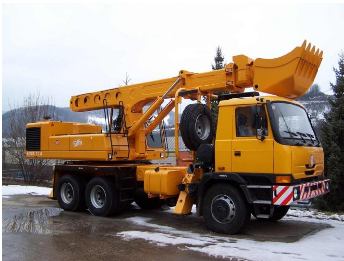
Obr. 13: Kolový podvozek automobilového typu (Zdroj:[18])
