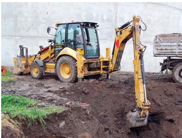
Obr. 10: Kolový podvozek traktorového typu (Zdroj:[30])
