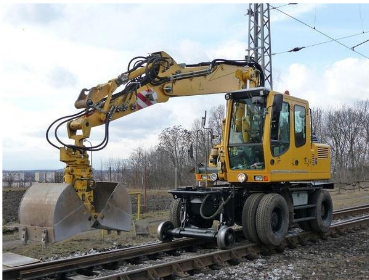
Obr. 11: Kolový podvozek na železničním svršku (Zdroj:[22])
