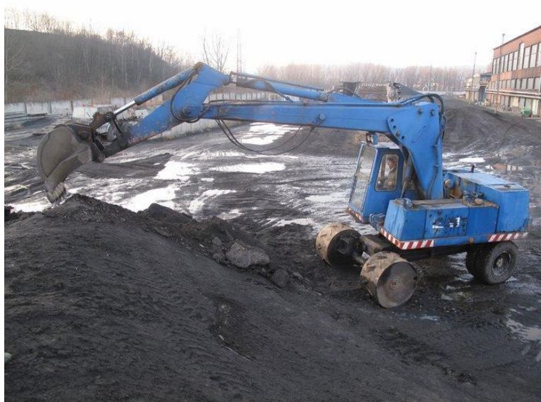
Obr. 12: Kolový podvozek typu Broyt (Zdroj:[20])
