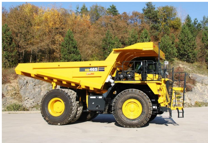
Obr. 26: Dempr s pevným rámem (Zdroj:[27])
