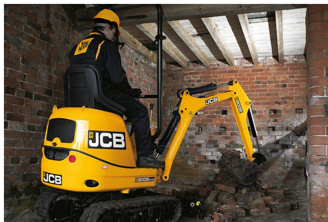
Obr. 4: Mikrorypadlo JCB 8008 CTS (Zdroj:[29])
