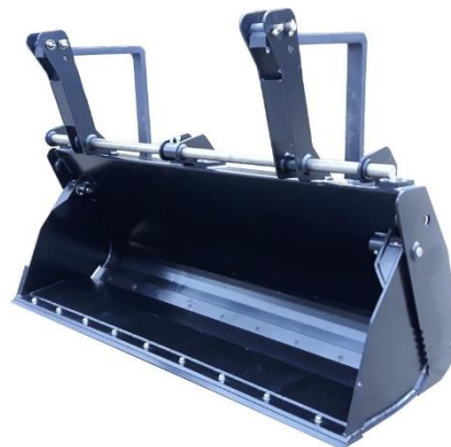
Obr. 21: Lopata nakládací čelist'ová (Zdroj:[25])
