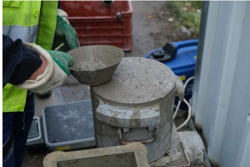
Obrázek 26: Nádoba tlakového přístroje na zkoušku obsahu vzduchu.
