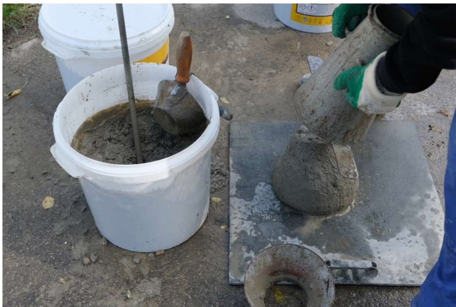
Obrázek 25: Zkouška sednutí Abramsova kužele po 150 minutách.
