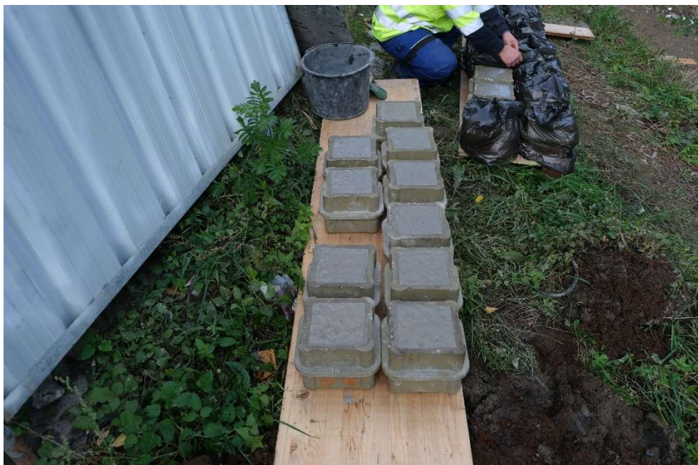
Obrázek 28: Krychle skladované na stavbě v průběhu měření.
