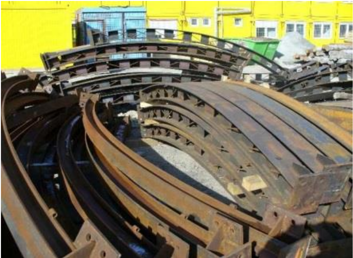
Obr. 10 Výztuž Hebrex použitá při stavbě Královopolského tunelu v Brně [6]
