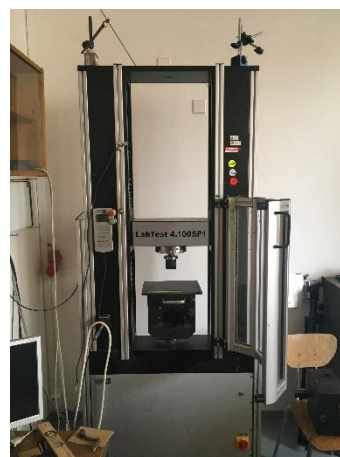
Obrázek 35: Jádrové vývrty u plných pálených cihel, zkušební lis LabTEST 4.100SP1
