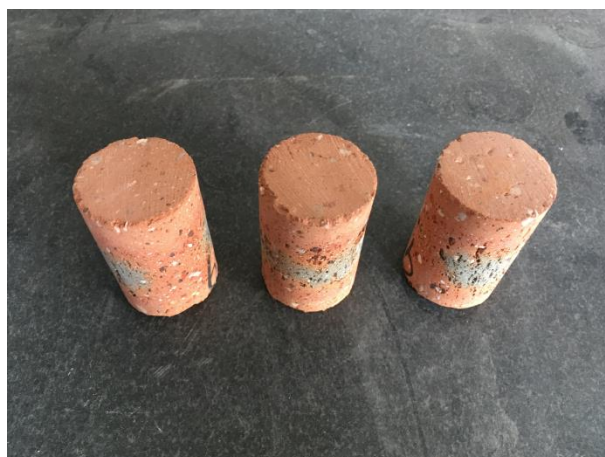
Obrázek 35: Jádrové vývrty u plných pálených cihel, zkušební lis LabTEST 4.100SP1
