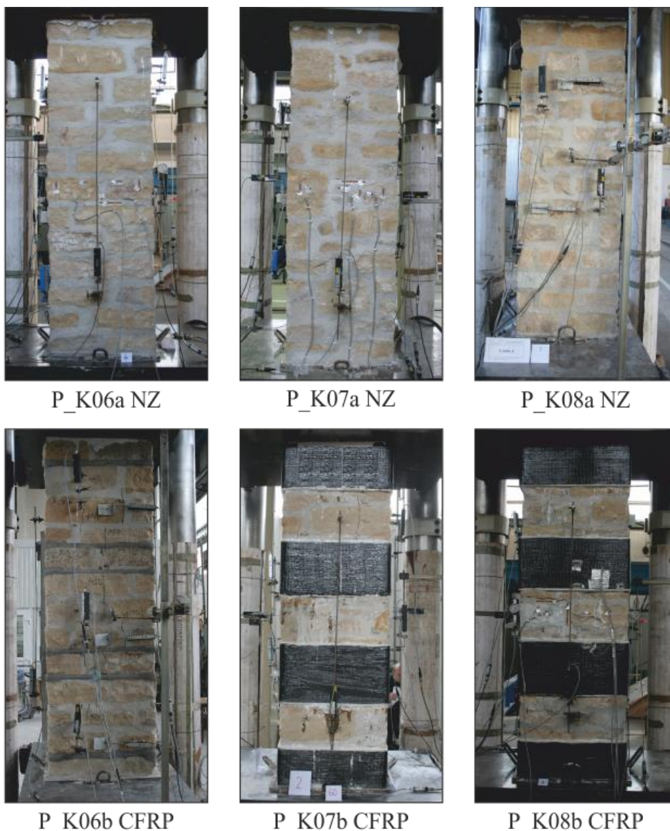
Obrázek 42: Kamenné pilíře experimentální sady s trhlinou po zesílení
