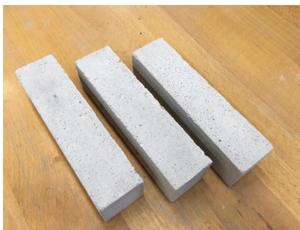
Obrázek 36: zkušební trámce z malty 40 x 40 x 160 mm
