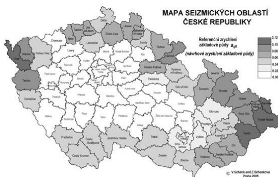
Obrázek 23: a) Mapa seismických oblastí ČR dle EC8, b/ Zemětřesení ve střední Evropě v letech 1995 - 1999 (citace: Zedník J., Plešinger A., Pazdírková J. (2004): Zemětřesení a seismologické observatoře. Pozn.: tektonická zemětřesení – červeně; důlní otřesy – modře; velikost symbolu odpovídá síle otřesu.
