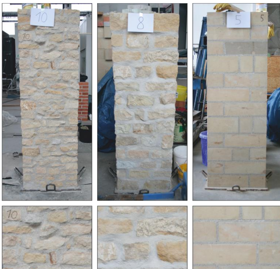
Obrázek 26: Kamenná zkušební tělesa: lomové zdivo z drobných zdicích prvků, řádkové zdivo, kvádrové zdivo z přesně řezaných bloků pískovce
