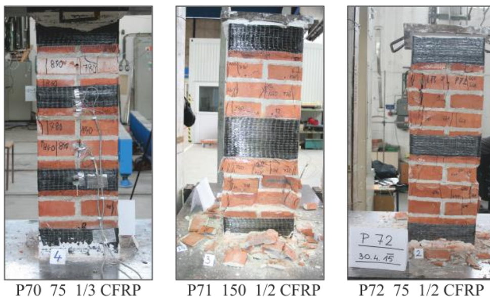
Obrázek 80: Fotodokumentace porušených pilířů experimentální sady P70 – P72.
