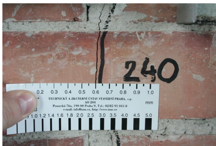
Obrázek 34: Dokumentace trhlin: měření šířky trhlin příložným pravítkem, zakreslení směru a orientace trhlin v protokole ke zkoušce.
