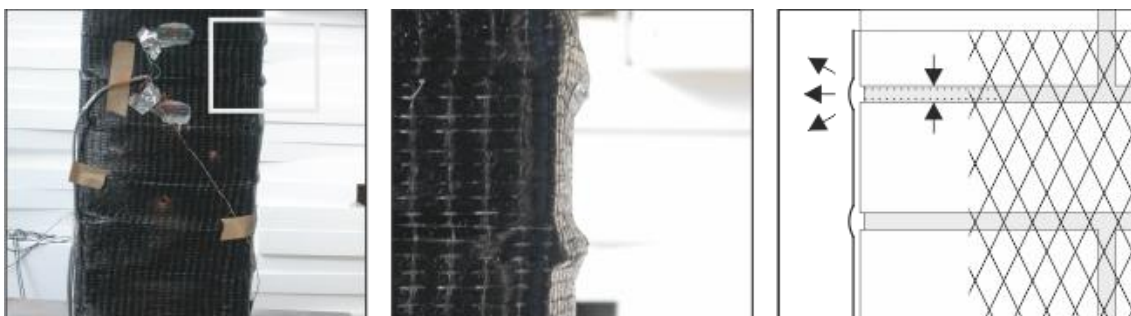
Obrázek 54: Porušování kontaktní spáry na rozhraní "kompozit – zdivo" boulením kompozitu v oblasti ložných spár překrytých kompozitním ovinutím. Svislé přetvoření malty přesahuje mezní přetvoření epoxidového adheziva: \varepsilon_{Y,malta} > \varepsilon_{Y,EPOX,max}
