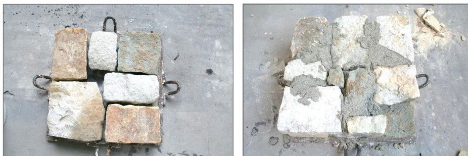
Obrázek 25: Kamenná zkušební tělesa: vyzdívání na podložku, vazba řádkového zdiva
