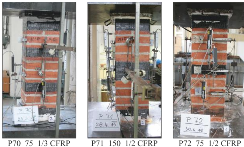
Obrázek 76: Pilíře P70 – P72 experimentální sady s rozdílnou geometrií a stupněm vyztužení. Fotodokumentace pilířů připravených před zatěžováním.
