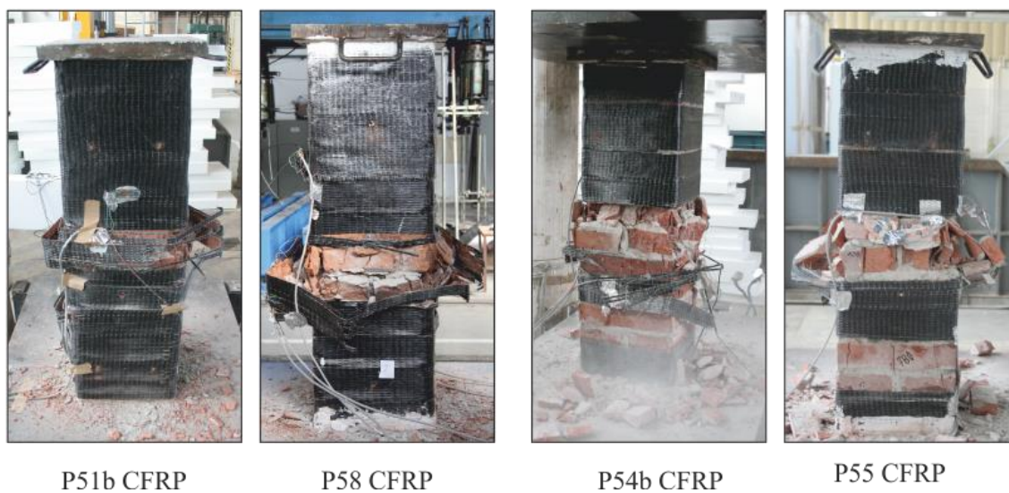
Obrázek 53: Fotodokumentace porušení pilířů s počáteční trhlinou v porovnání s pilíři P58 a P55.
