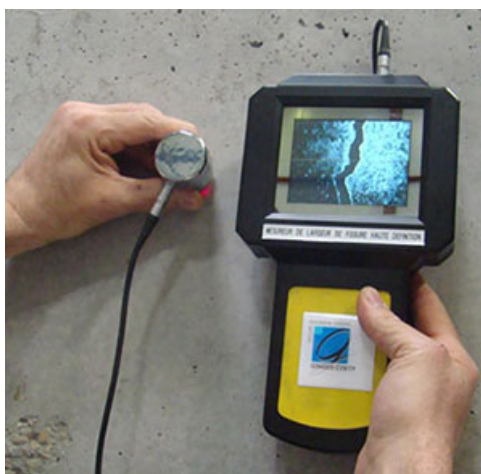
Obrázek 2.4: Měření trhlin pomocí kamery[7]
