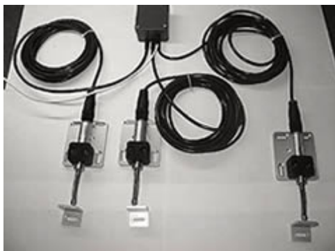
Obrázek 2.8: Monitorování trhlin pomocí senzorů a dataloggeru[7]
