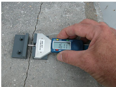
Obrázek 2.5: Digitální měřič trhlin GINGERCEBTP [7]
