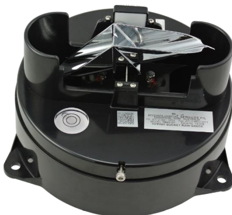
Obrázek 12 - Příklad senzoru s principem překlápěcích vaniček[28]
