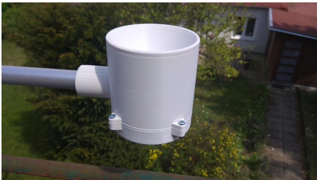
Obrázek 33 - Hotový senzor deště
