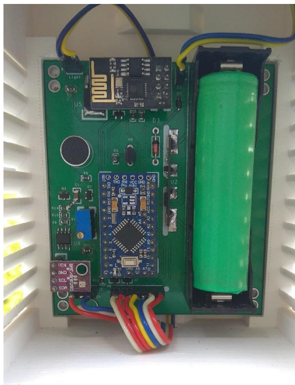
Obrázek 34 - Osazená deska plošných spojů uvnitř krabičky hlavní jednotky
