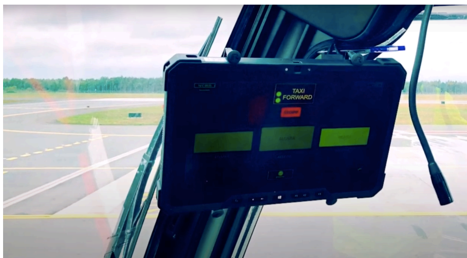
Obrázek 3-9: Umístění ovládacího tabletu v kabině odmrazovacího vozu
