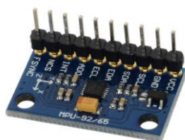
Obrázek 14: Modul MPU92/65 s akcelerometrem, gyroskopem, magnetometrem, teploměrem a tlakoměrem [25]
