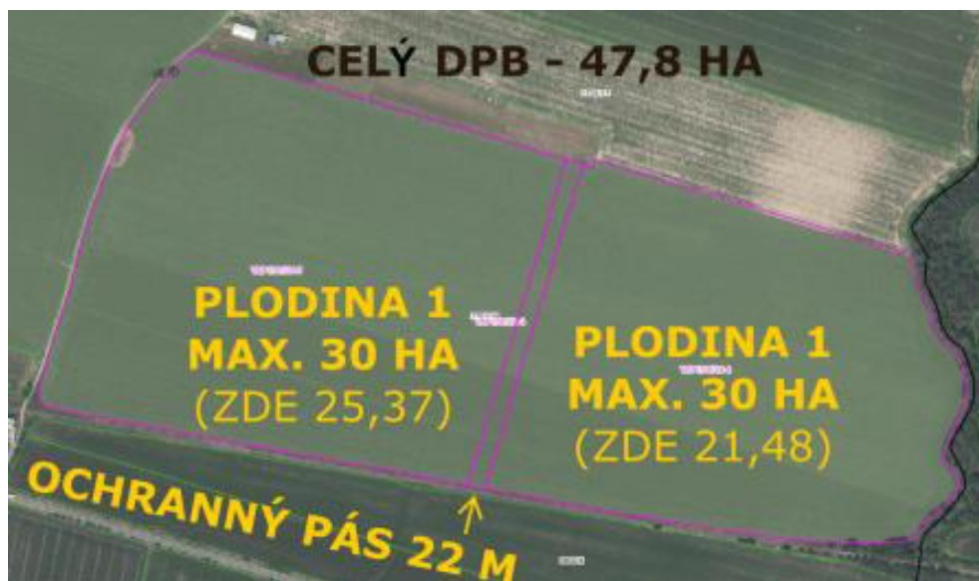
Obr. 8 - Náskres protierozního opatření s 22metrovým pásem [12]
