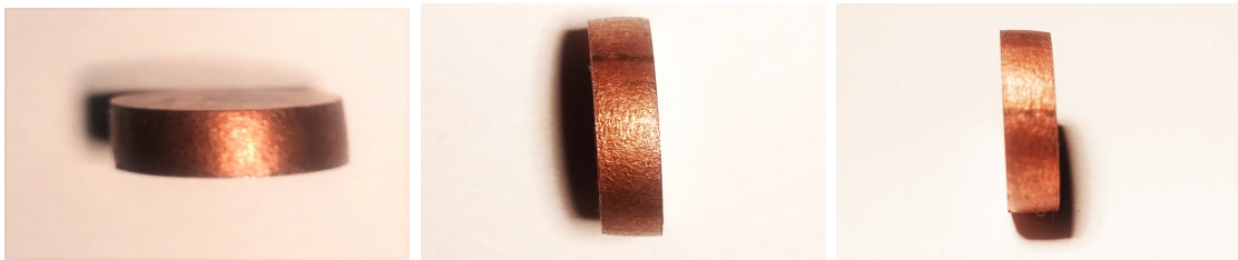
Obrázek 8.25: Vzorek po proběhlé tlakové zkoušce - původní délka 5 mm, průměr 10 mm, nová délka 3 mm, průměr 12 mm
