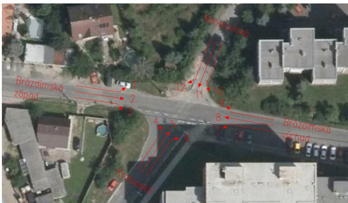
Obrázek 11 – Schéma dopravních proudů průsečné křižovatky
