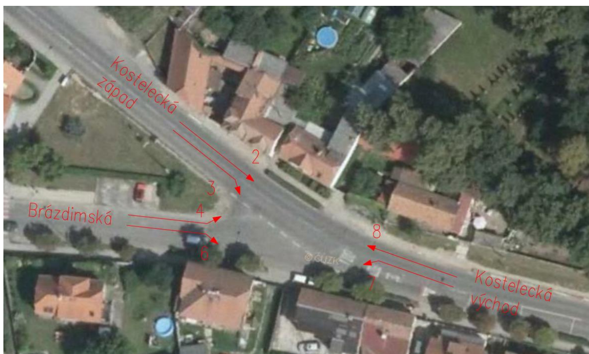
Obrázek 9 – Schéma dopravních proudů stykové křižovatky
