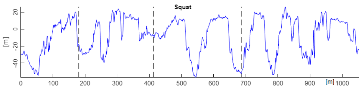
Obrázek 11: Graf s matematickým kanálem squat. Data byla naměřena na okruhu ve Vysokém Mýtě se spalovacím motocyklem.
