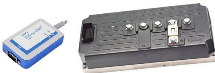
Obrázek 28: Vlevo – převodník Ixaat V2, vpravo – controller elektrického motocyklu Sevcon Gen4.
