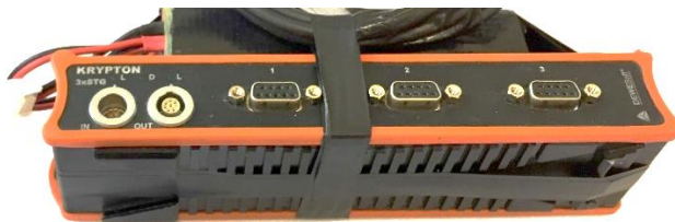
Obrázek 27: Tříkanálová měřicí jednotka Krypton 3XSTG se sloty pro snímače, baterii a konektory pro připojení k PC.
