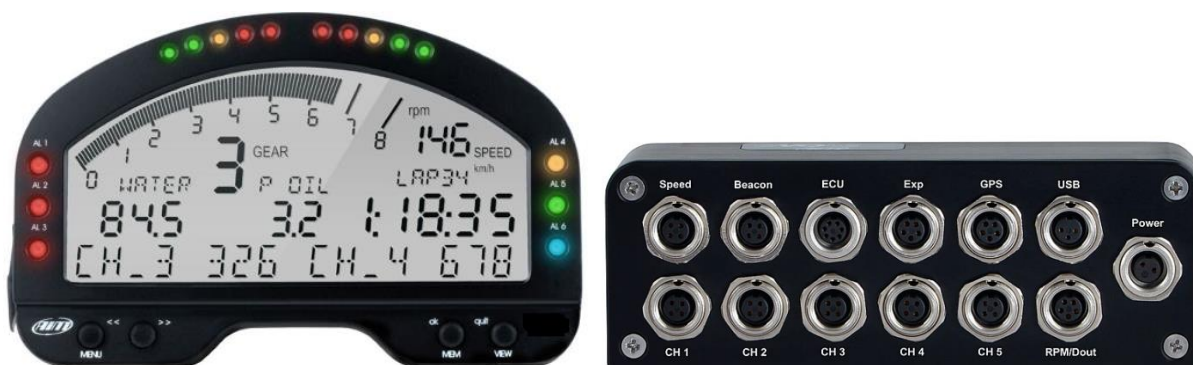
Obrázek 12: Vlevo – multifunkční displej, vpravo – záznamová jednotka, tzv. „datalogger“.
