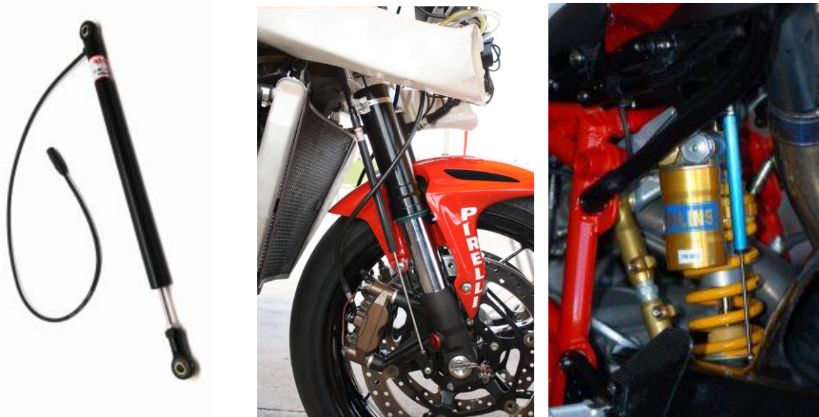
Obrázek 14, 15, 16: Lineární potenciometry a jejich možné umístění na podvozek motocyklu [5] [6].
