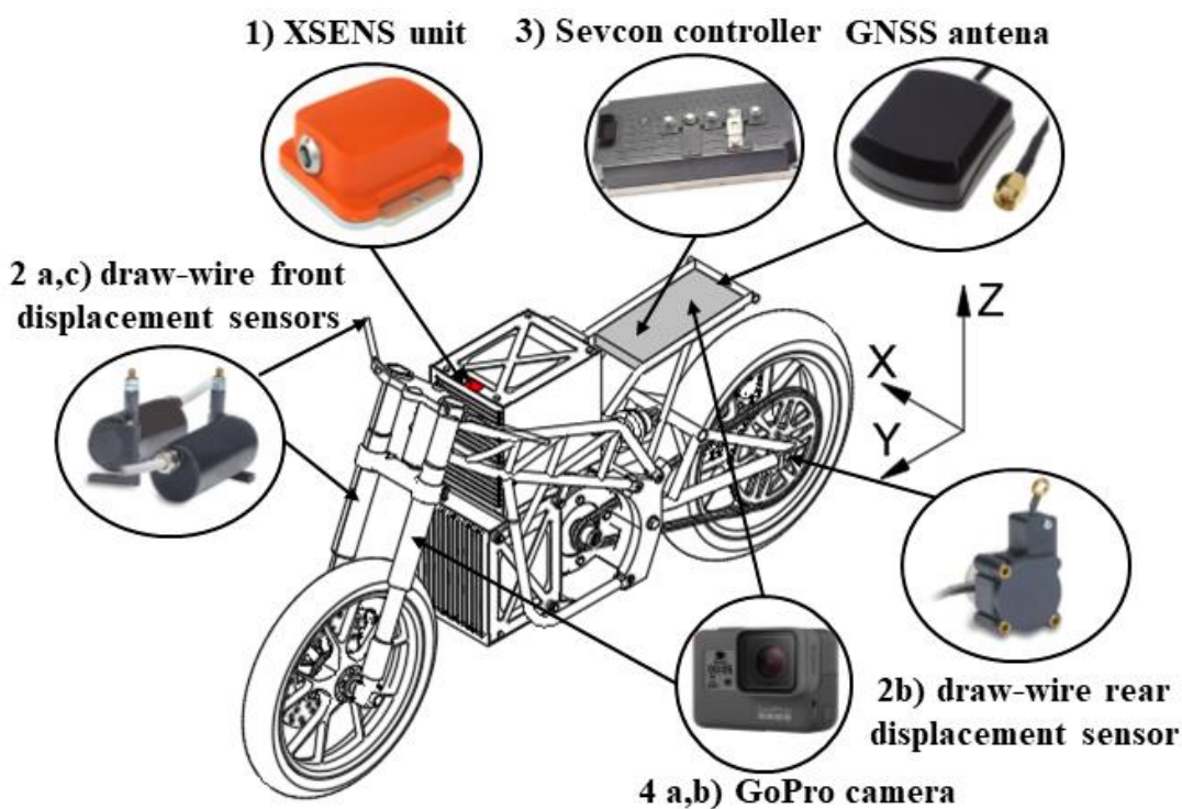
Obrázek 33: Osazení podvozku elektrického motocyklu měřicí technikou.
