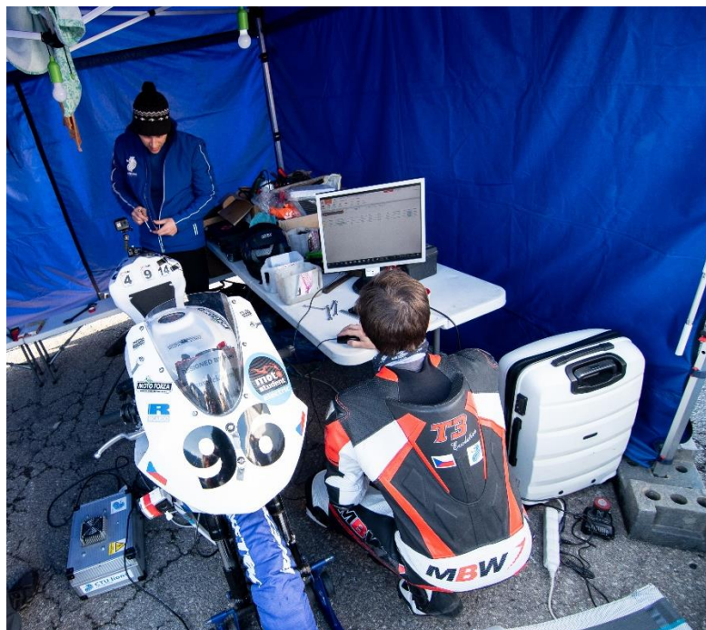
Obrázek 46: Nabíjení a kalibrace potenciometrů elektrického motocyklu – příprava na druhý trénink.
