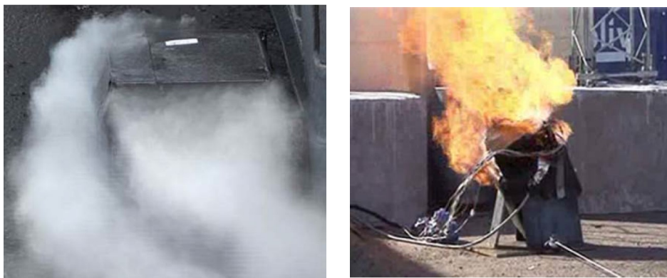
OBRÁZEK 5.1: Ukázka reakce baterie po poškození [29]
