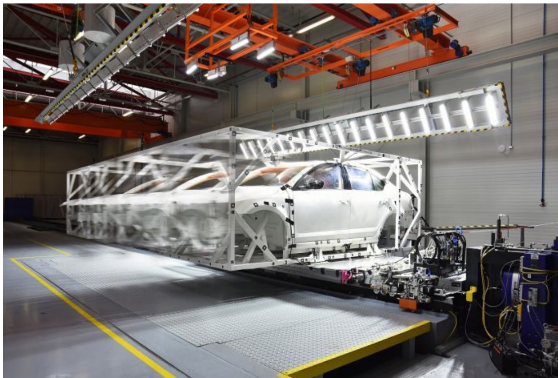
OBRÁZEK 6.2: DYCOT - Skelet karoserie při dynamickém pulzu [32]
