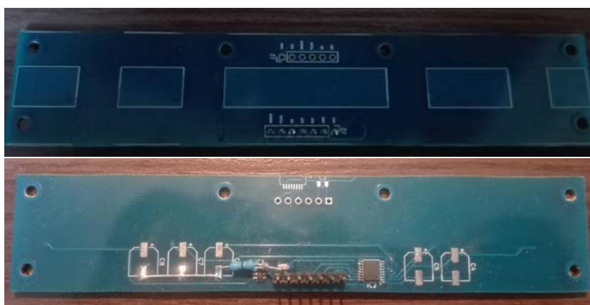
Obrázek 3.6: Výsledný modul centrálního panelu s tlačítky – horní část vlevo a spodní část vpravo – vlastní foto.
