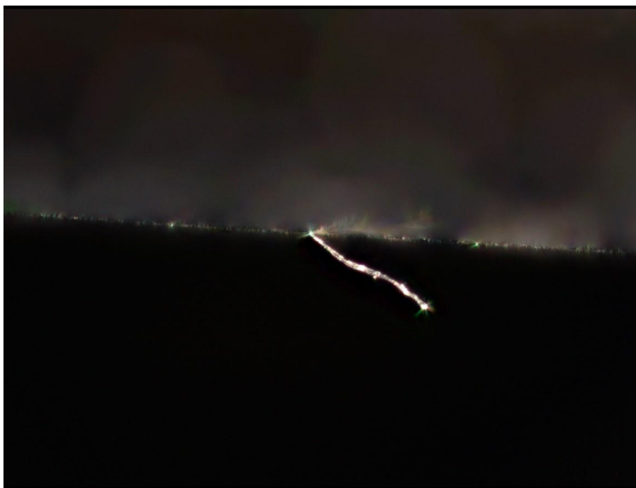
Obrázek 44. Whisker na vzorku SnCu1 - 50 °C - vzorek 3
