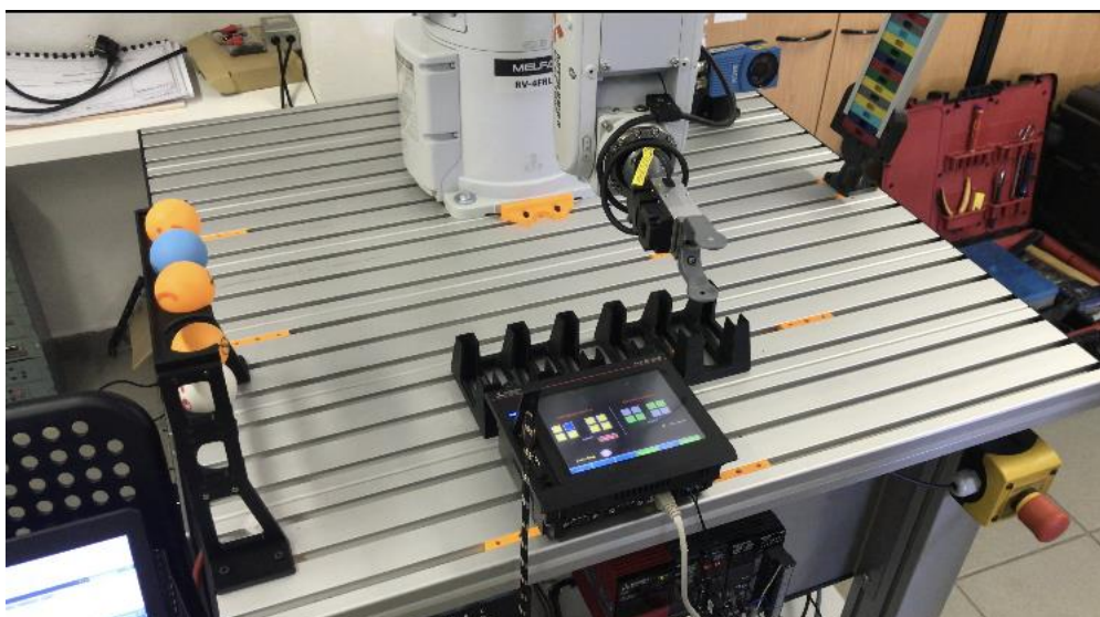
Obr. 27 – Reálné pracoviště ovládané HMI panelem
