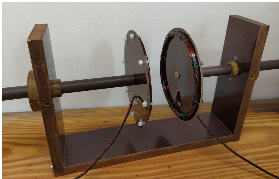
Obr. 3-2 : Přípravek pro nastavení vzdálenosti cívek
