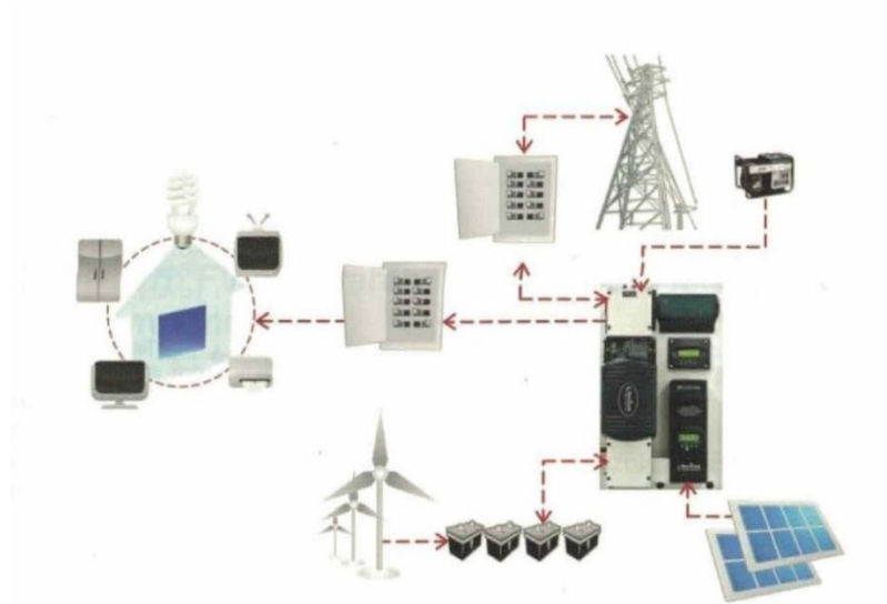
Obrázek č. 13 – zapojení hybridního FV systému [11]
