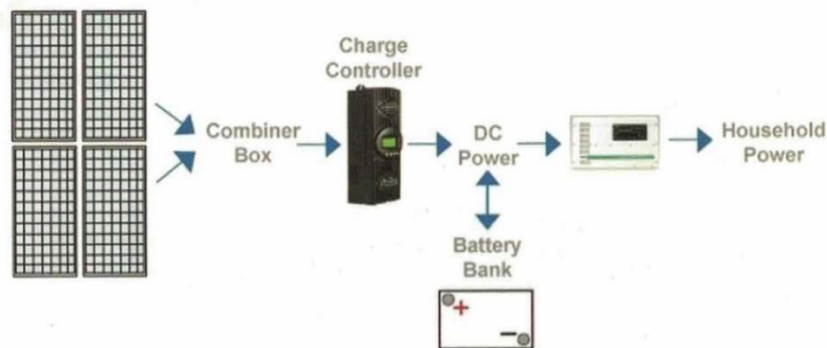
Obrázek č. 12 – blokové schéma systému Grid-off [11]
