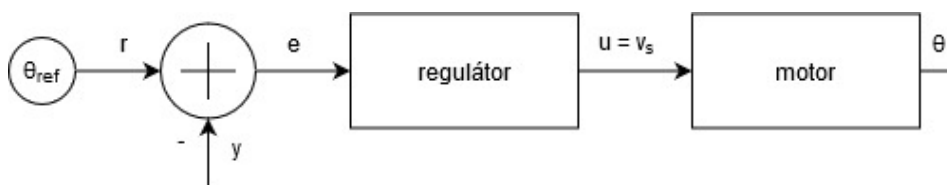
Obrázek 2.8: Schéma zpětnovazební regulace úhlu natočení rotoru
