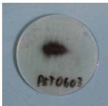
Obrázek 59- Průřez vzorku PET0603 na DC zkoušce s kladnou polaritou
