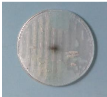
Obrázek 33- Proražený vzorek PET na krátkodobé zkoušce s AC napětím
