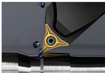
Nový koncept technologie podélného a čelního soustružení – PrimeTurning (Sandvik Coromant)
