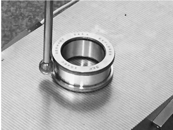
(a) Měření geometrie vnitřního kroužku ložiska na souřadnicovém měřicím zařízení Prismo od firmy Carl Zeiss
