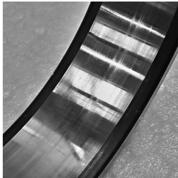
Obr. 6.25: Znamky rovnoměrného zaběhnutí ložiska na vnějším kroužku.
