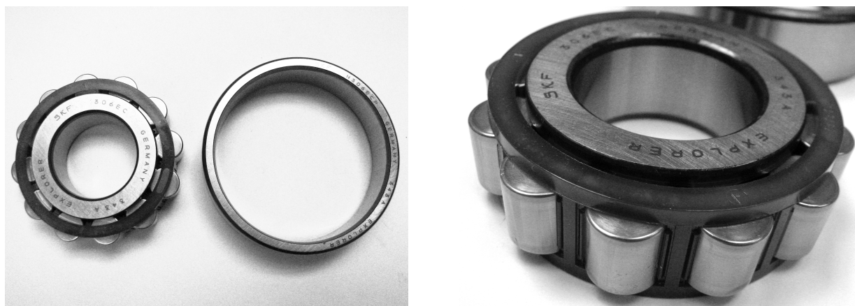
(a) Rozložené ložisko N306. Na obrázku je jasně patrné vedení elementů na vnitřním kroužku. (b) Detail na valivé elementy ložiska a vedení klece ve střední části válečků.
