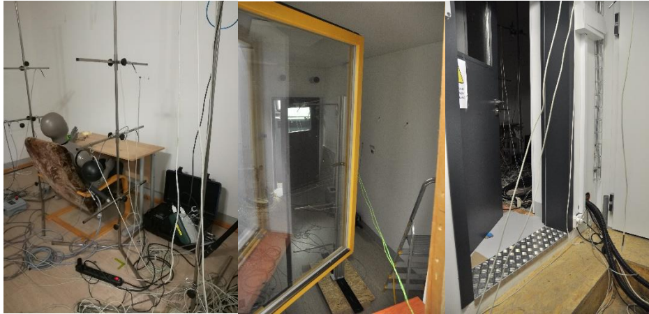
9.7 Obr. Fotodokumentace z konfigurace jednotlivých experimentálních měření – TMČ s ambientními čidly, okno a dveře otevřené na 30° (autor)
