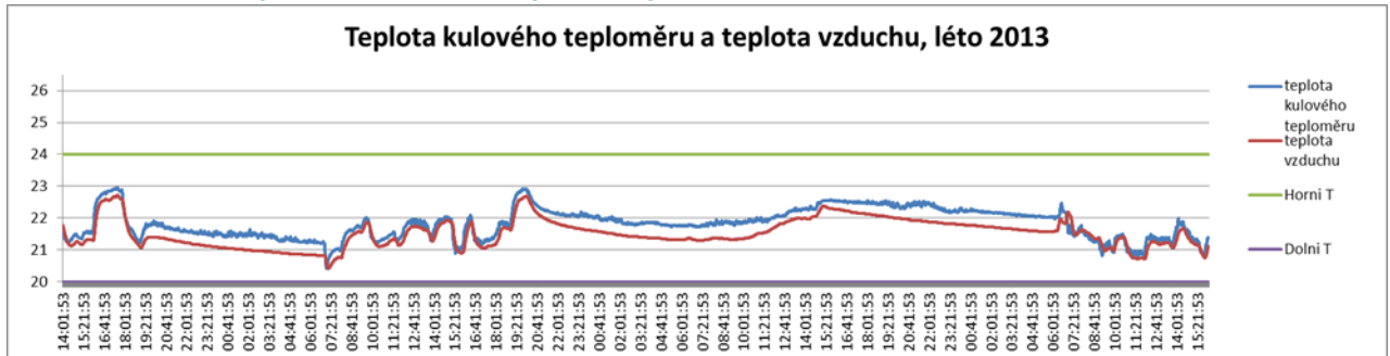
17.1 Obr. teplota kulového teploměru v C215 – letní podmínky (autor)
