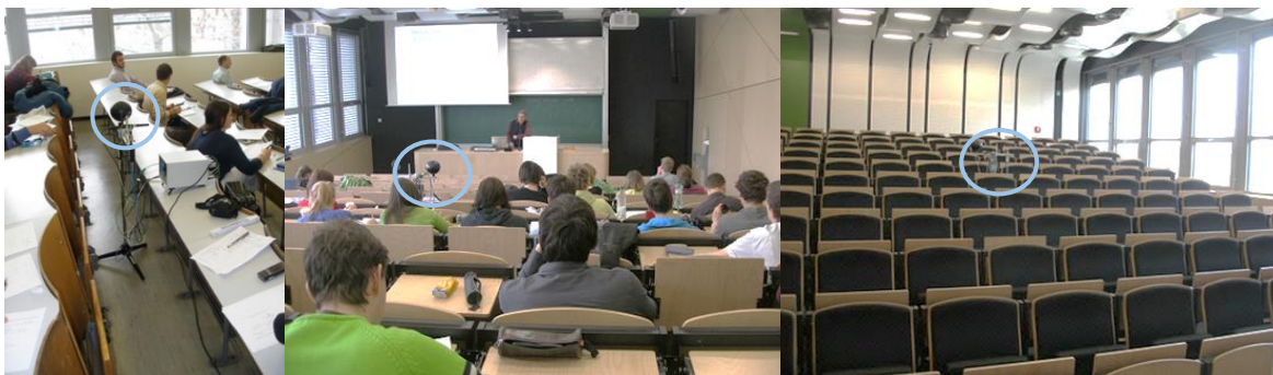
6.6 Obr. Fotografie z měření v posluchárně C215 před a po rekonstrukci – umístění měřicího stojanu (autor)
