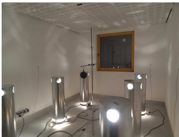
Obr. 4 Pohled do komory při měření chladicího výkonu (varianta M1).
