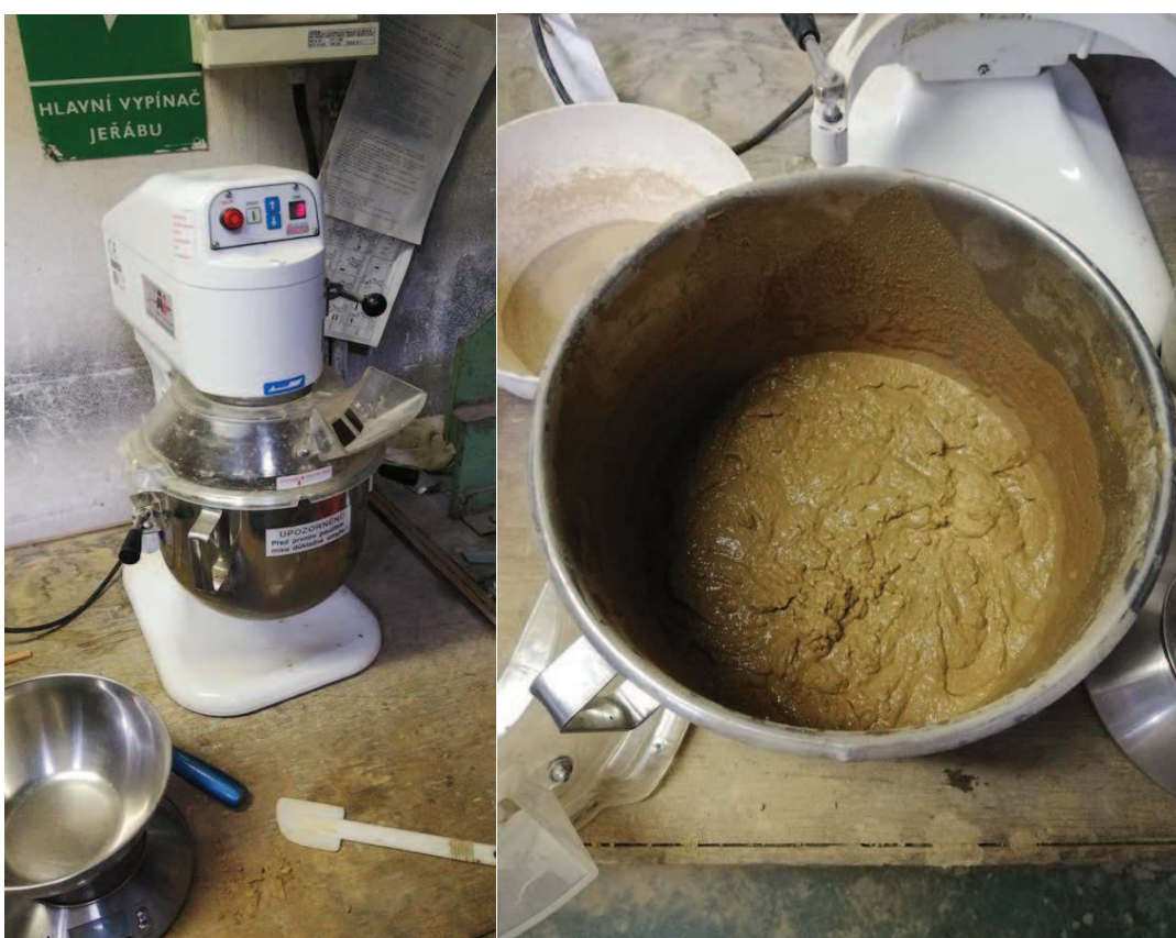
Obrázek 5.2: Univerzální kuchyňský robot SP-800A a umíchaná omítková směs
