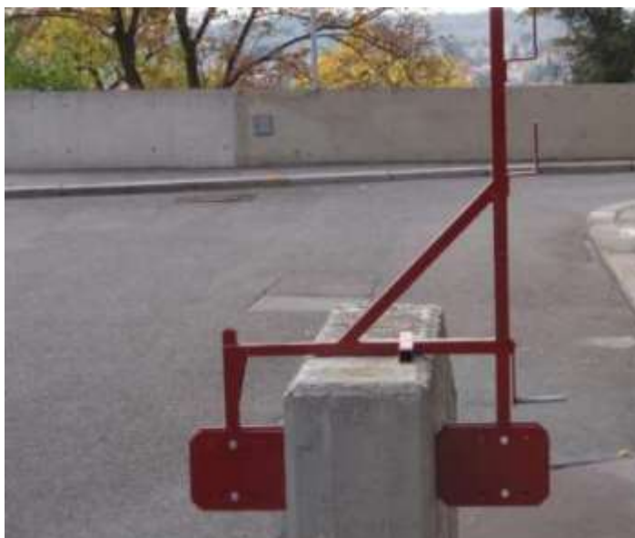
Obrázek 27 - Ochranné zábradlí na atiku [28]
