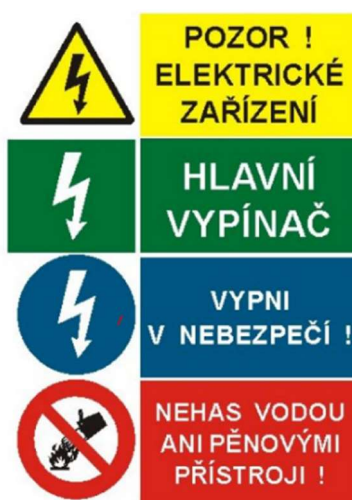
Obrázek 13 - Označení elektrických zařízení [13]
