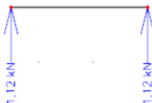
Obrázek 41 - Reakce - Stropní nosník 2,5 m (Stálé zatížení)
