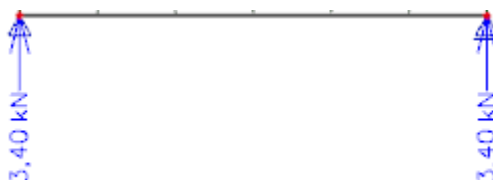
Obrázek 40 - Reakce - Stropní nosník 6,2 m (Stálé zatížení)
