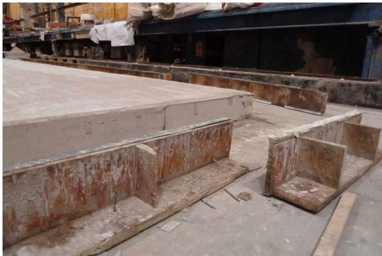
Obrázek 4.7: Tesařské bočnice hotového prvku
