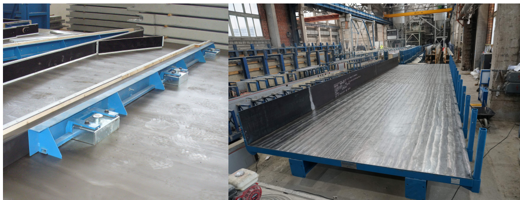
Obrázek 1.4: Vytvářecí plocha z ocelového plechu, magnetické bočnice [17]
