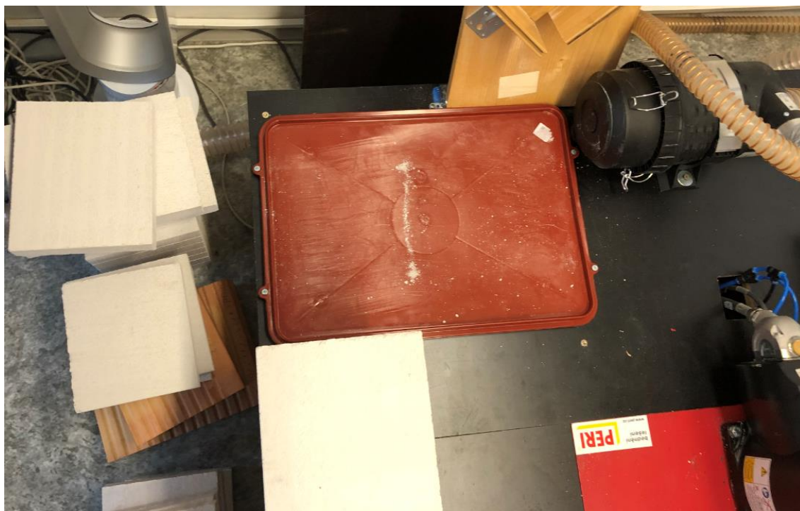
Obr. 72 Podložka s hranami pro maltovou směs, převzato z [26]
