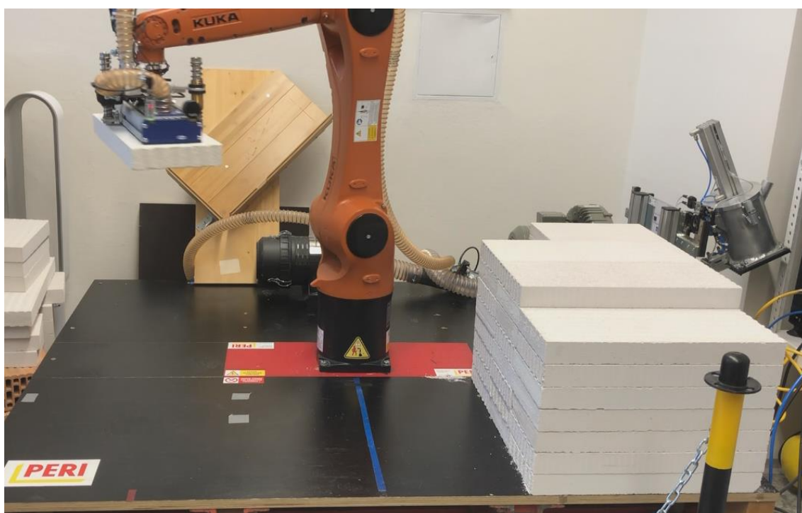
Obr. 67 Nabrání a přesun cihly do rektifikačního zařízení, autor Jan Illetško
