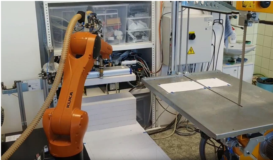
Obr. 58 Nadzdvihnutí prvku pomocí přísavky, autor Jan Illetško
