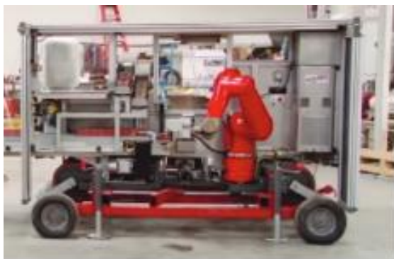
Obr. 12 Hlavní mobilní modul stavebního robota SAM, převzato z [21]
