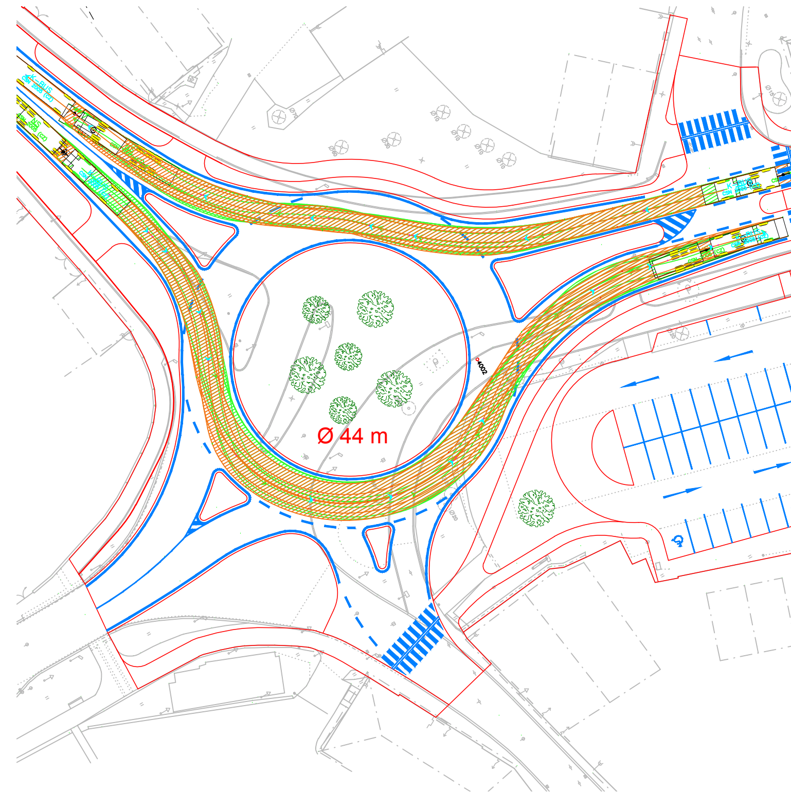
Prověření průjezdu kloubového autobusu a nákladní soupravy okružní křižovatkou.
