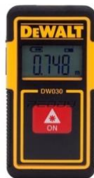
obr. 1.7 DeWALT DW030PL-přístroj použitý na měření
