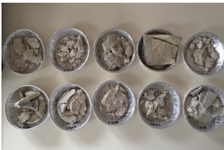
obr. 2.24 Vzorky pro gravimetrickou metodu
