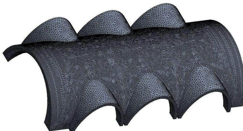
Obrázek 42 - 3D model klenby s vygenerovanou sítí [autor]
