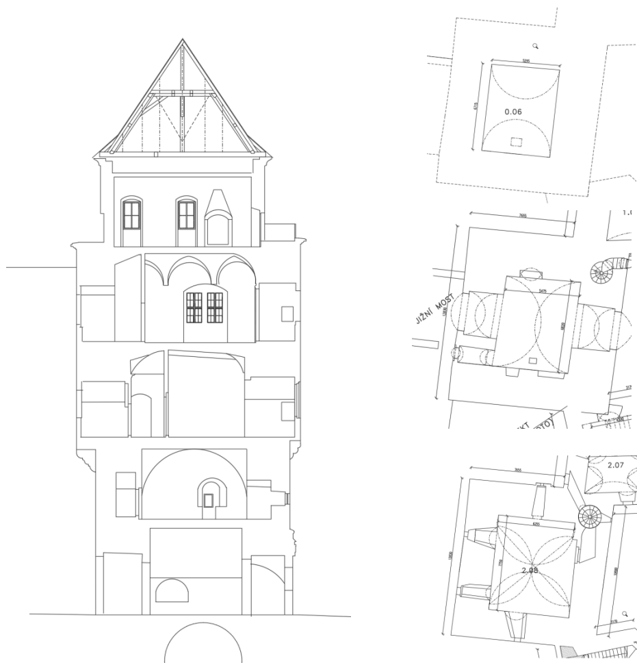
Obr.7: Řez a půdorysy (0-2NP) věže Rožmitálského zámku
