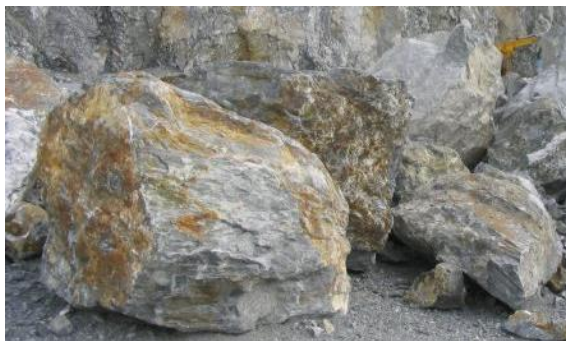
Obrázek 17 – Těžená hornina - spilit [46]
