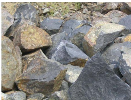
Obrázek 19 - Těžená hornina - čedič [47]
