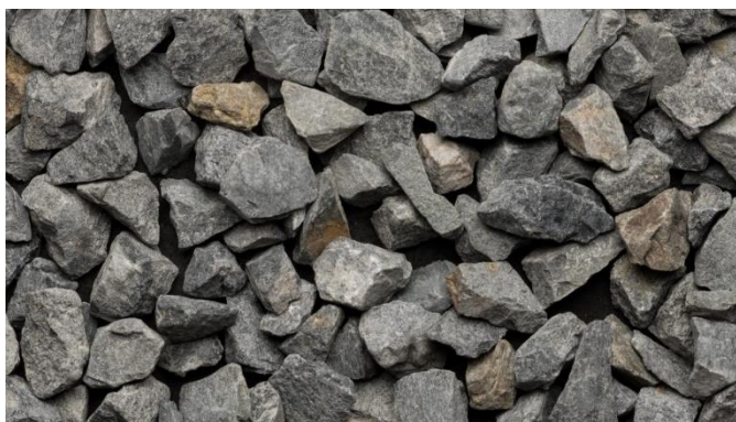
Obrázek 12 - Frakce 8/11 těžného kameniva [23]
