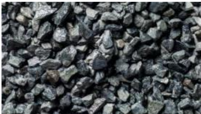
Obrázek 5 - Frakce 8/11 těžného kameniva [14]
