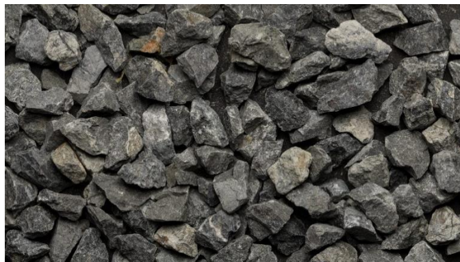
Obrázek 10 - Frakce 8/11 těženého kameniva [21]
