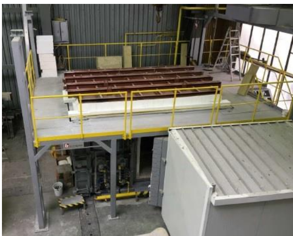
Obr. 45 Horizontální pec ve zkušebně PAVUS, a. s. ve Veselí nad Lužnicí; převzato z [25]
