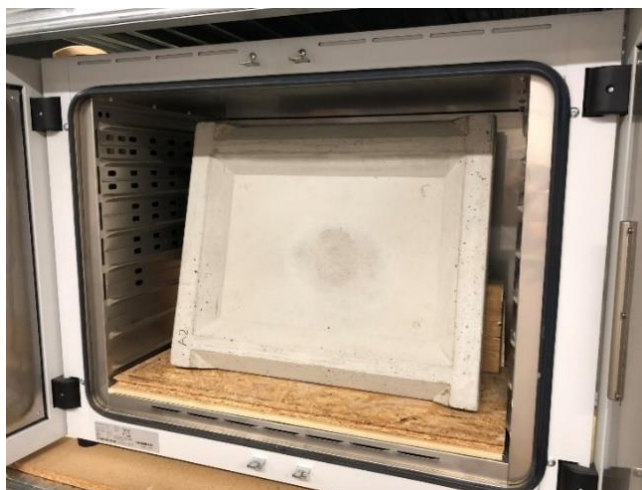
Obr. 14 Umístění vzorků A1, A2 v teplovzdušné sušárně
