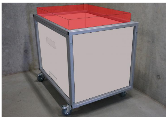
Obr. 10 Mobilní požární pec v sestavení pro zkoušení vodorovných prvků; převzato z [23]
