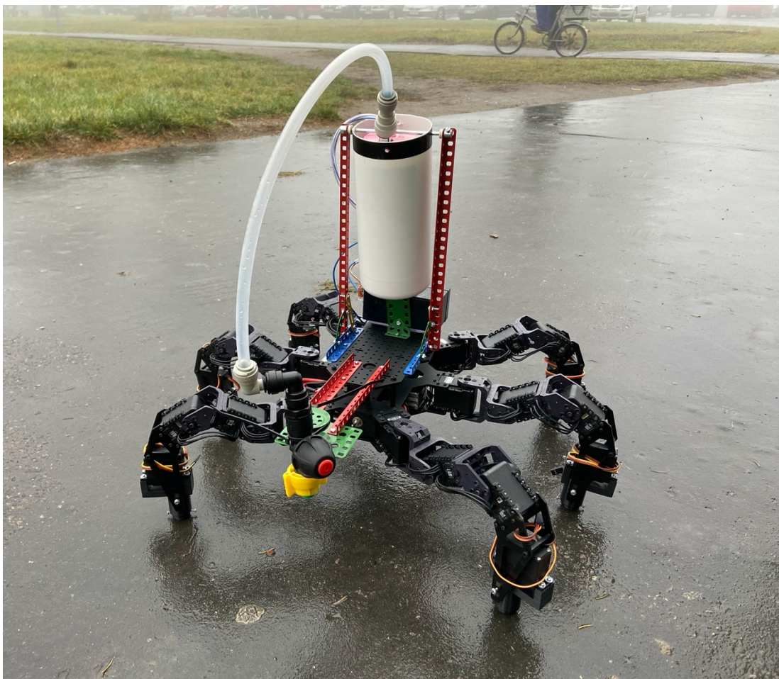
Obrázek 56 - Testování uchycení hlavice na hexapod - vodorovná poloha
