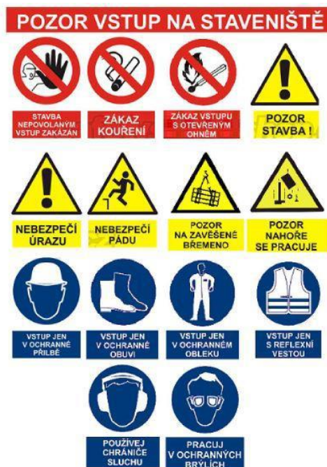
7 Obr. č.7 Informační tabule před vstupem na staveniště
