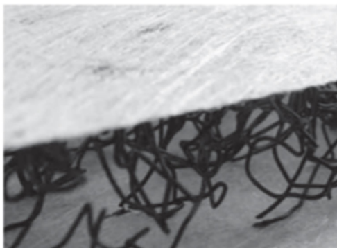
Obrázek 29 Drátěný drenážní systém s ochranou [6]
