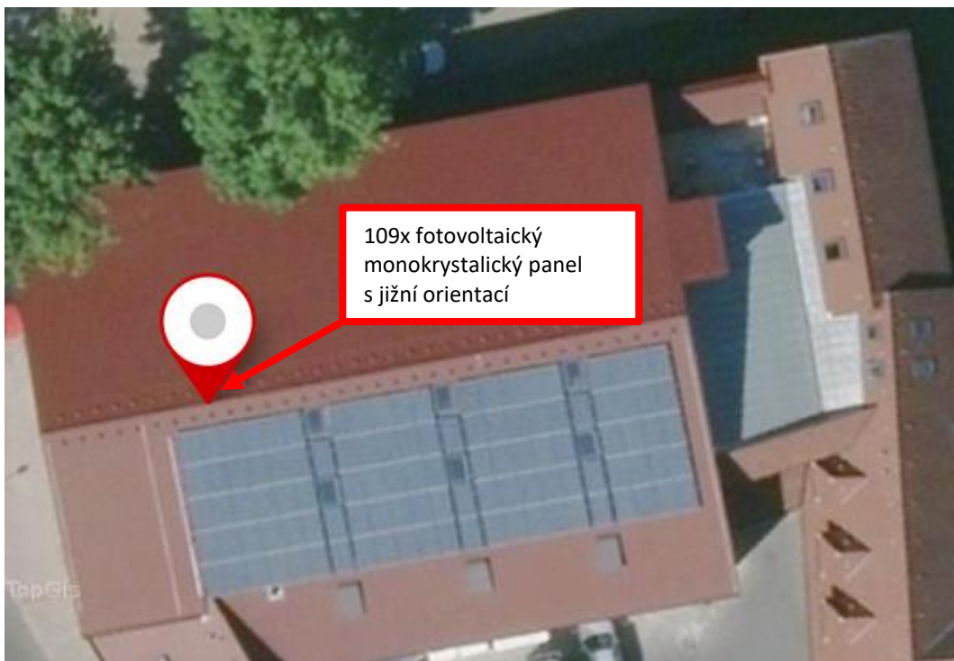
Obr.6 – Pohled shora na fotovoltaický systém
