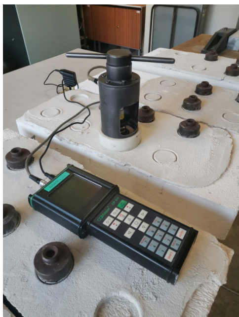
Obrázek 4.9 Měření přídržnosti odtrhoměrem OMtest OP ¾
