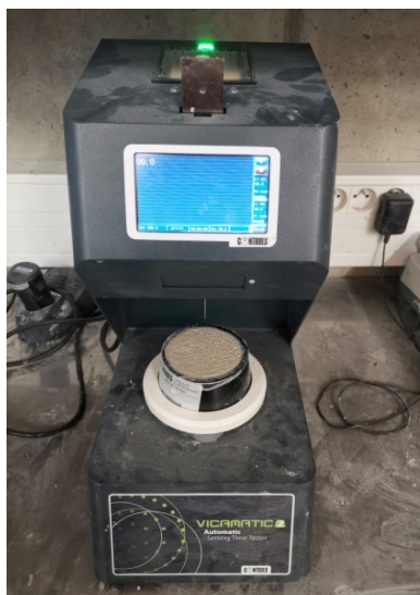
Obrázek 4.1 Automatický Vicatův přístroj v průběhu zkoušky
