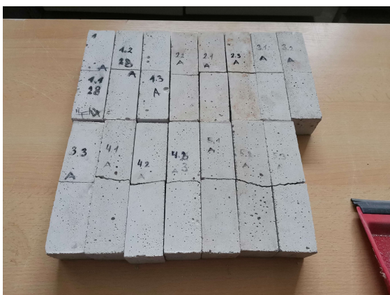
Obrázek 3.5 Trámečky porušené zkouškou pevnosti v tahu za ohybu
