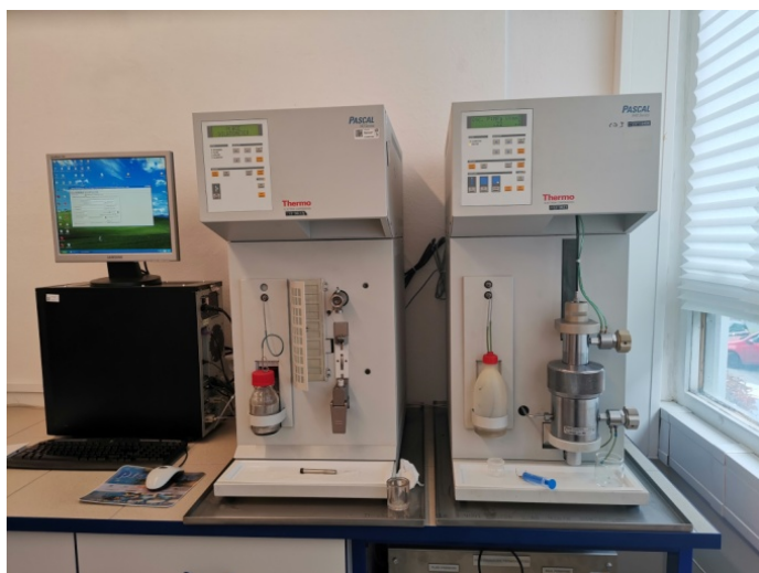
Obrázek 3.3 Porozimetry Pascal 140 a 440 od výrobce Thermo Electron
