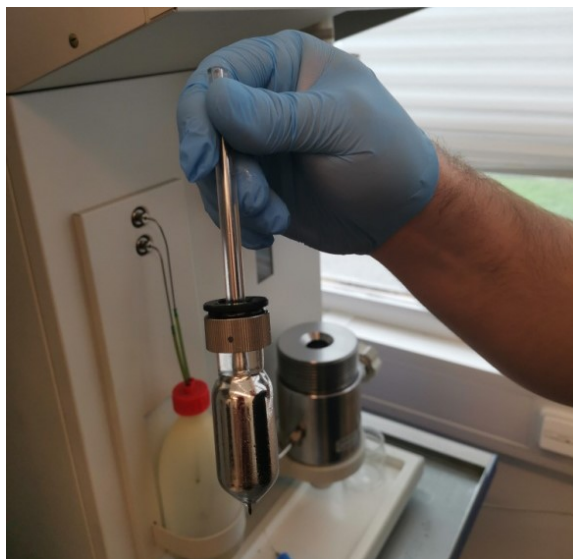
Obrázek 4.5 Vzorek s vtačenou rtuť
