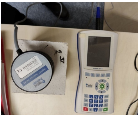
Obrázek 4.11 Měření tepelné kapacity pomocí přístroje Isomet 2114
