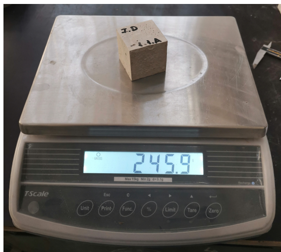
Obrázek 3.2 Stanovení hmotnosti vzorku laboratorní váhou TScale QHW 15
