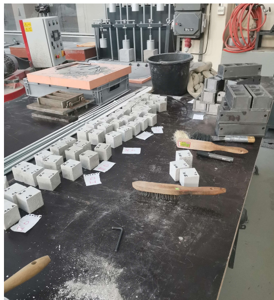
Obrázek 3.12 Příprava vzorků pro zjištění pevnosti v tlaku
