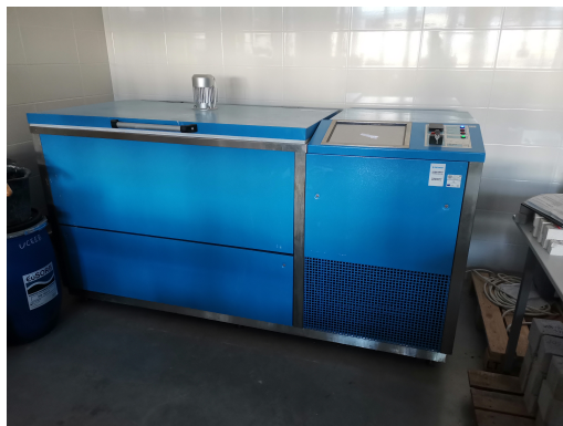
Obrázek 4.12 automatické zařízení KD 20, pro vyhodnocení zkoušek mrazuvzdornosti
