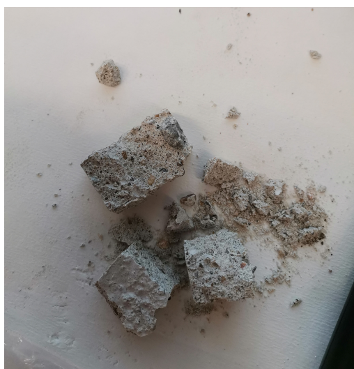
Obrázek 4.7 Nadrcený vzorek na heliovou pyknometrii
