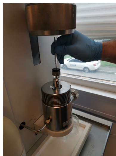
Obrázek 3.4 Vzorek naplněný rtuť
