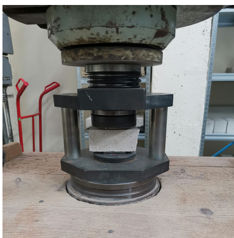
Obrázek 3.7 Vzorek umístěný v lisu před zkouškou pevnosti v tlaku
