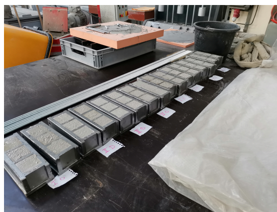
Obrázek 3.18 výroba zkušebních krychlí 50 x 50 x 50 mm
