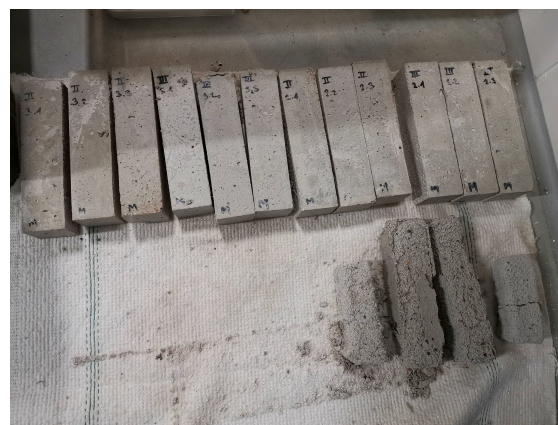
Obrázek 4.13 Vzorky v automatickém zařízení KD 20 v průběhu první zmrazovací etapy Obrázek 4.14 Vzorky po ukončení první zmrazovací etapy
