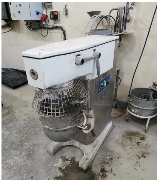
Obrázek 3.11 Použitá stavební míchačka na přípravu malt
