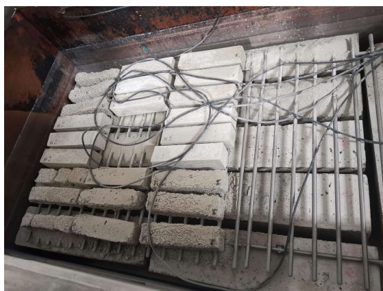
Obrázek 4.13 Vzorky v automatickém zařízení KD 20 v průběhu první zmrazovací etapy Obrázek 4.14 Vzorky po ukončení první zmrazovací etapy
