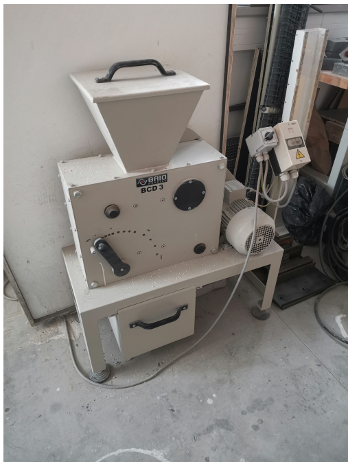
Obrázek 3.9 Použitá drtička pro úpravu recyklovaného pórobetonu
