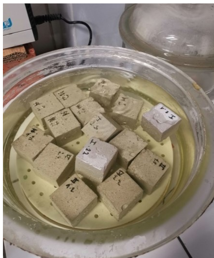
Obrázek 4.8 Vzorky ponořené do vody při vakuové saturaci
