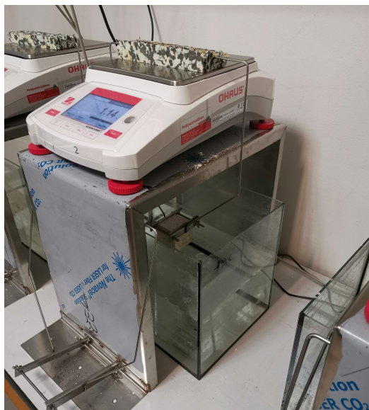
Obrázek 4.3 Vzorek zavěšen pomocí speciální konstrukce na digitální váze
