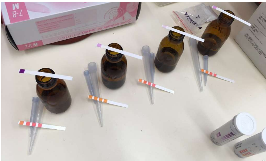
Obrázek 50: Určení přítomnosti solí pomocí analytických testovacích proužků
