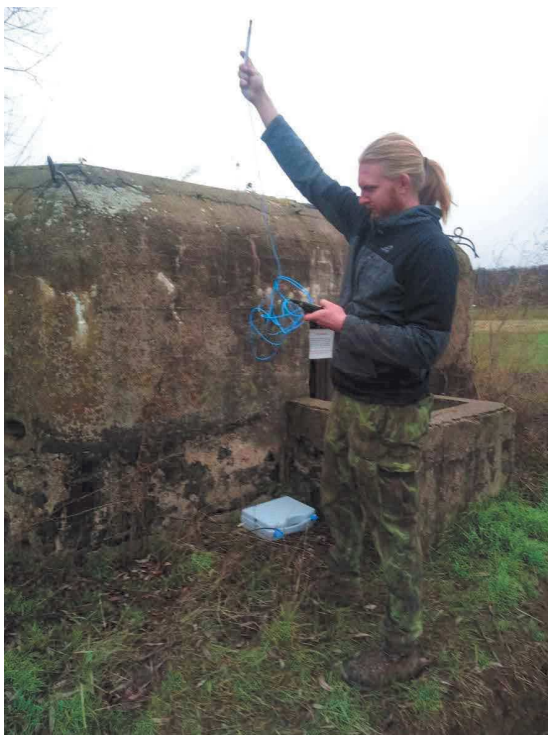
Obr. 146 a 26 Měření rychlosti proudění vzduchu v exteriéru ( v_e ) a v interiéru ( v_{i1,2} )
