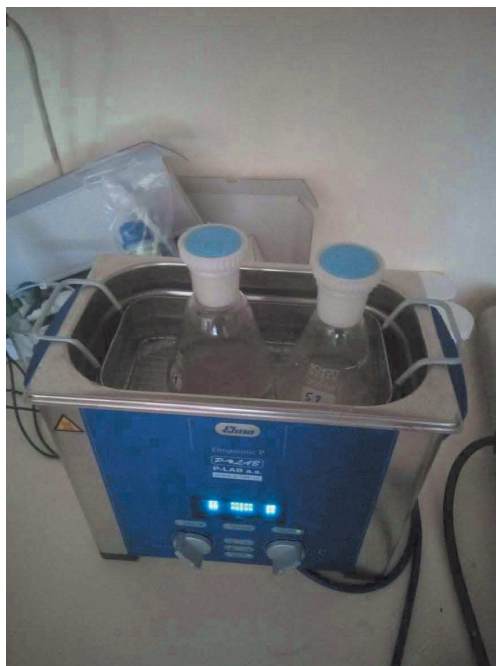
Obr.170 Zahřívání vzorků S1 a S2 pomocí ultrazvuku
