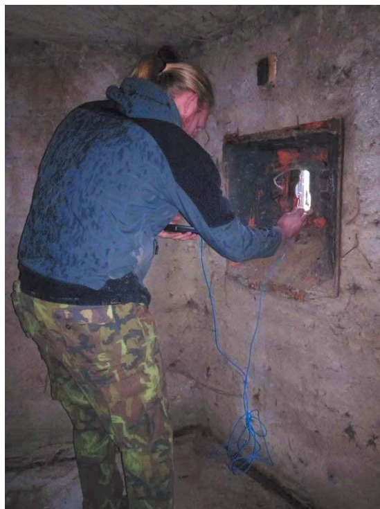
Obr. 146 a 26 Měření rychlosti proudění vzduchu v exteriéru ( v_e ) a v interiéru ( v_{i1,2} )
