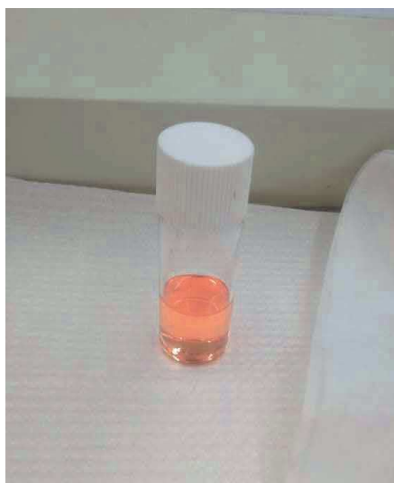
Obr. 167 Zkouška na přítomnost síranů
