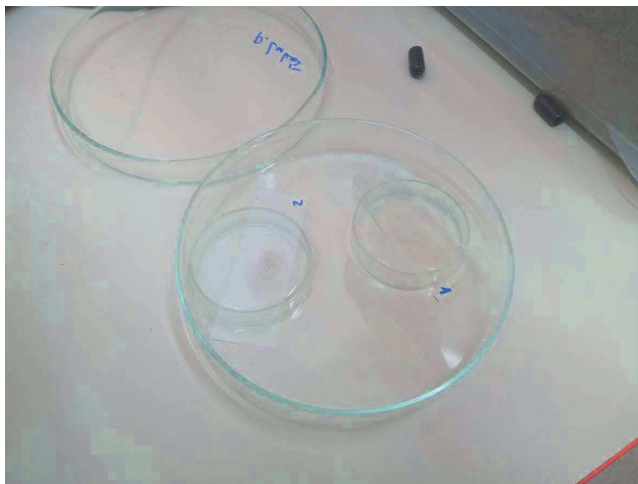
Obr. 174 Vzorky vápenných výkvětů na mikroskopických sklíčkách
