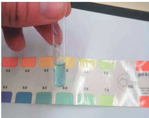
Obr. 165 Kolorimetrické měření pH
