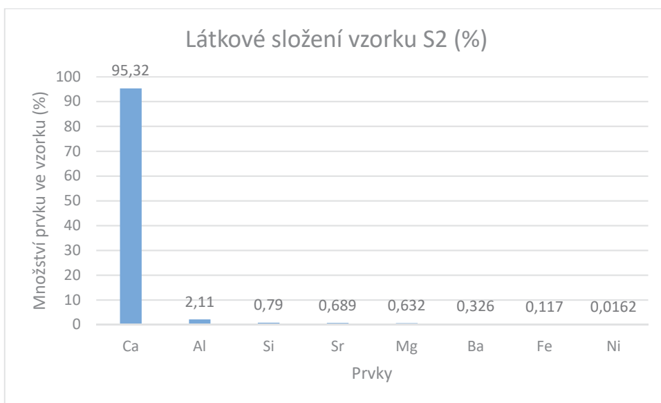
Obr. 172 Výsledky ED – XRF analýzy – Látkové složení vzorku S2
