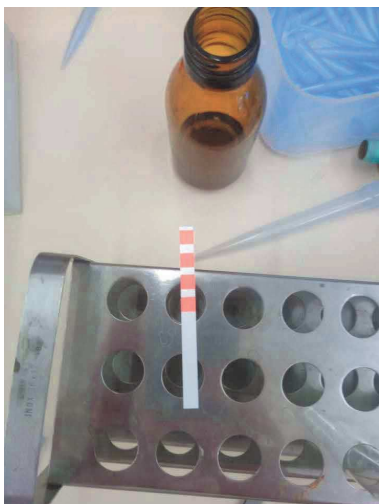
Obr. 164 Kolorimetrické měření – dusičnany
