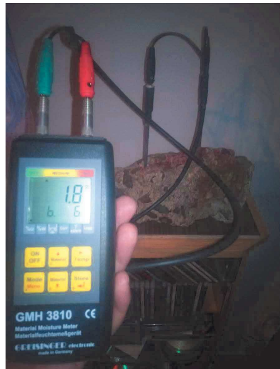
Obr. 160 Měření vlhkosti vzorku betonu
