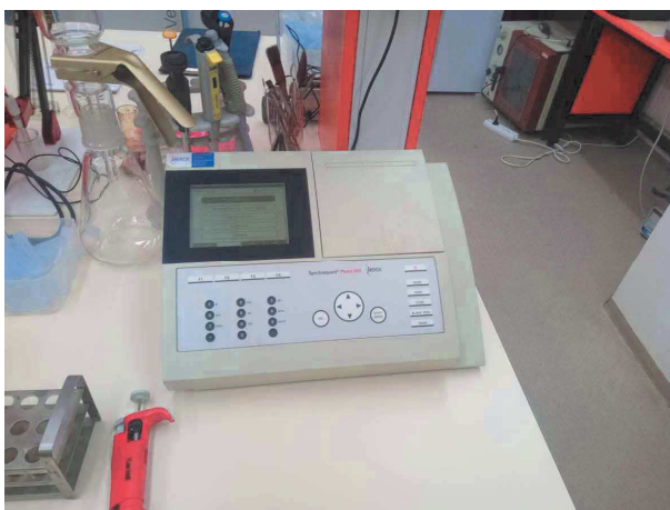
Obr. 166 Fotometrický přístroj Spectroquant® Pharo 300
