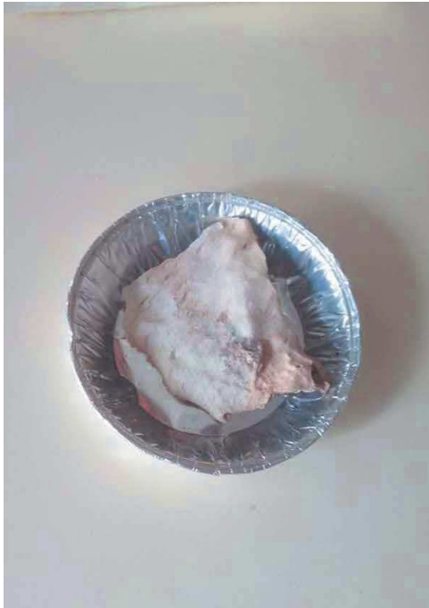
Obr. 162 Vzorek vápenného výkvětu – Mradice (S1)
